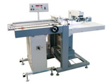
Flachstapelanleger FSA mit Ausrichttisch ART Flat pile feeder FSA with alignment table ART
