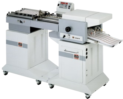
multipli 35 PBA mit Unterflursauganleger und Ausrichttisch multipli 35 PBA with bottom-feed, top-loading suction feeder and alignment table
