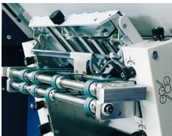
Einhängbares Zusatzfalzwerk KF 31 mit zwei Taschen. Erhöht die Falzvariabilität und ermöglicht Kleinfaltungen. Additional fold unit KF 31 with two fold plates. Increases the fold variability and makes small folds possible.
